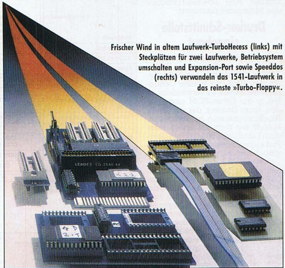
Frischer Wind in altem Laufwerk-TurboAccess (links) mit Steckplätzen für zwei Laufwerke, Betriebssystem umschalten und Expansion-Port sowie Speeddos (rechts) verwandeln das 1541-Laufwerk in das reinste »Turbo-Floppy«.
